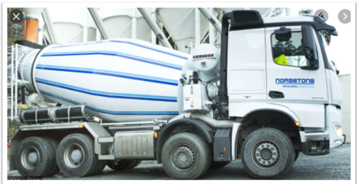
Figur 8. Betongbil 10 m lang og ca. 25 - 30 tonn totalvekt
