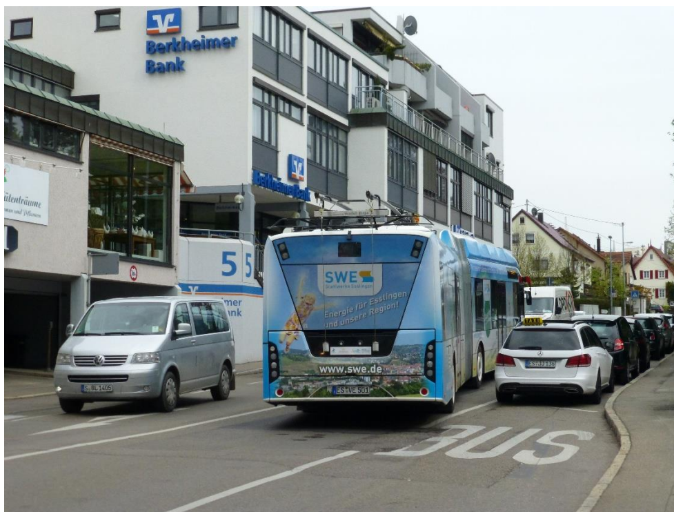
Figur 7 IMC-buss i Esslingen med nedfelte trolleytenger som kjører på batteri. Foto: PG Andersson
