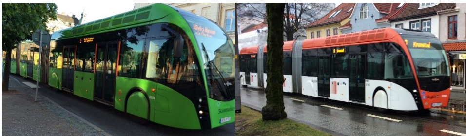
Figur 2-2 24-meters gasshybridbusser ruller i dag i Malmö (t.v.) og Bergen (t.h.). Produsent Van Hool. Foto: Hannes Englessen.
