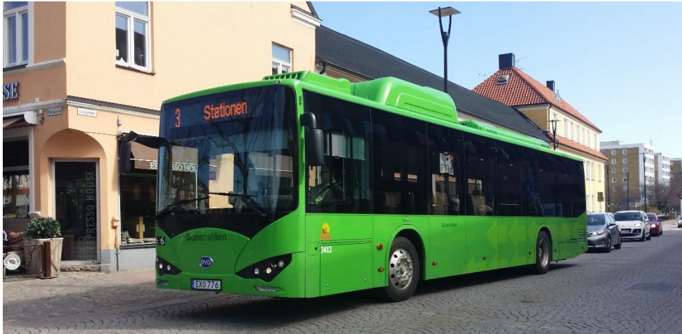
Figur 2-3 Batteridrevet depotladet standardbuss i Ängelholm. Producent BYD. Foto: Ida Blank.
