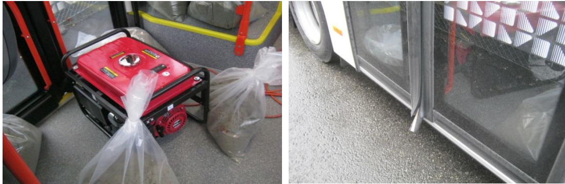
Strømforsyning fra medbragt bensinaggregat (avgassrøret til høyre)
