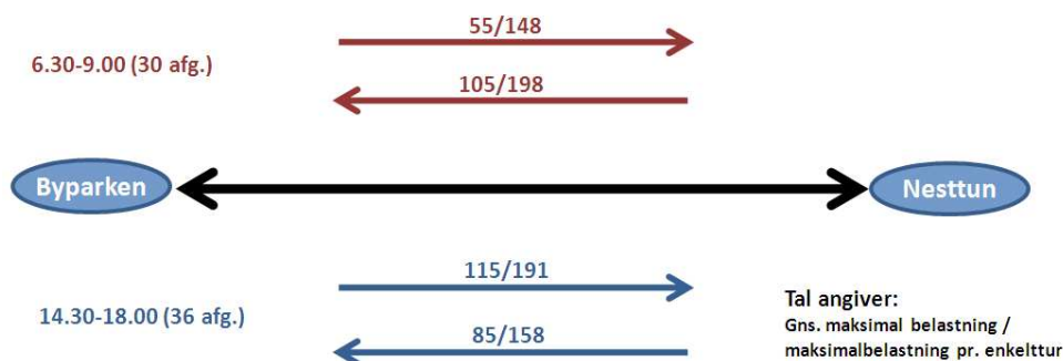
Figur 3.3 Diagram over maksimalbelastningen i rush-tiden målt som det maksimale antal samtidige passagerer pr. vogn. Første tal viser gns. belastning i maksimalsnittet over hele tælleperioden, men andet tal viser det højeste antal registrerede samtidige passagerer i tælleperioden.
